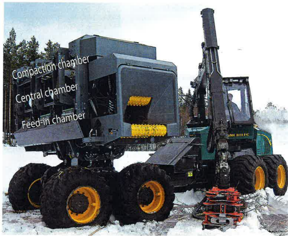
Kuva 1. Fixteri-paalausyksikkö muodostuu syöttökammioista (feed-in chamber), keskikammioista (central chamber) ja pakkausammioista (compaction chamber). (valokuva Rolf Björheden, Skogforsk).
